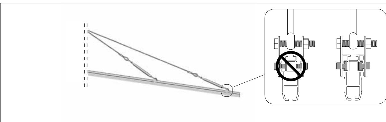
Montera stagfästena i löpskenans T-spår. Kontrollera noga att T-spårsmuttern låser fast som den ska i T-spåret.
