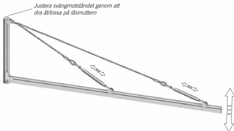
När svängarmen är uppmonterad på önskad plats kan du justera vinkel genom att justera vantskruvorna. Lås sedan vantskruvorna med låsmuttrarna.
